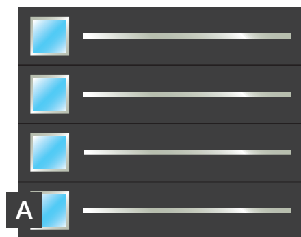
Modèle A : 4 motifs plats : 30 x 1500 mm 4 hublots collés ABA carrés vitrage composite glace PMMA sablé : 300 x 300 mm
